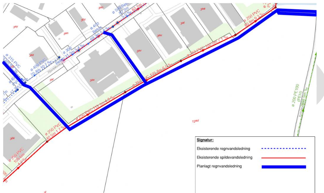
Figur 5. Eksisterende og planlagt kloakering på området.
