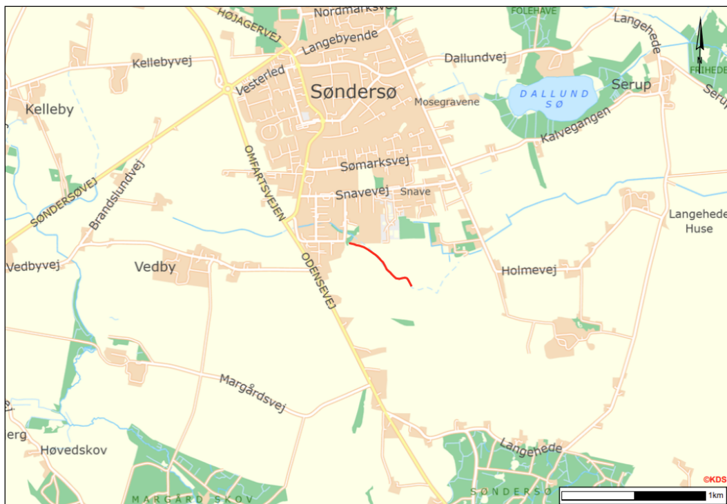
Figur 1: Oversigtskort. Den røde linje markerer den rørlagte strækning af Vedbyrenden med afløb mod øst, der ønskes genåbnet. Målestok er angivet i nederste højre hjørne. Baggrundskort © SDFI, 31.08.2026/WMS-tjeneste, skærmkort, almindeligt.
