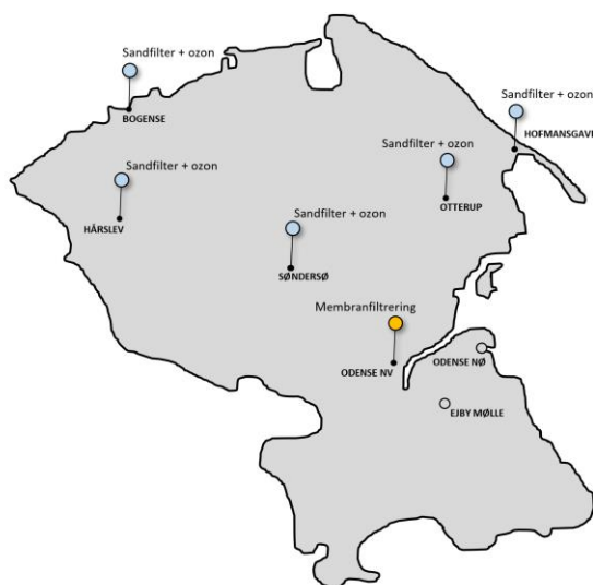
Figur 1 Decentral struktur med bevarelse af nuværende punktkilder og etablering af avanceret rensning
