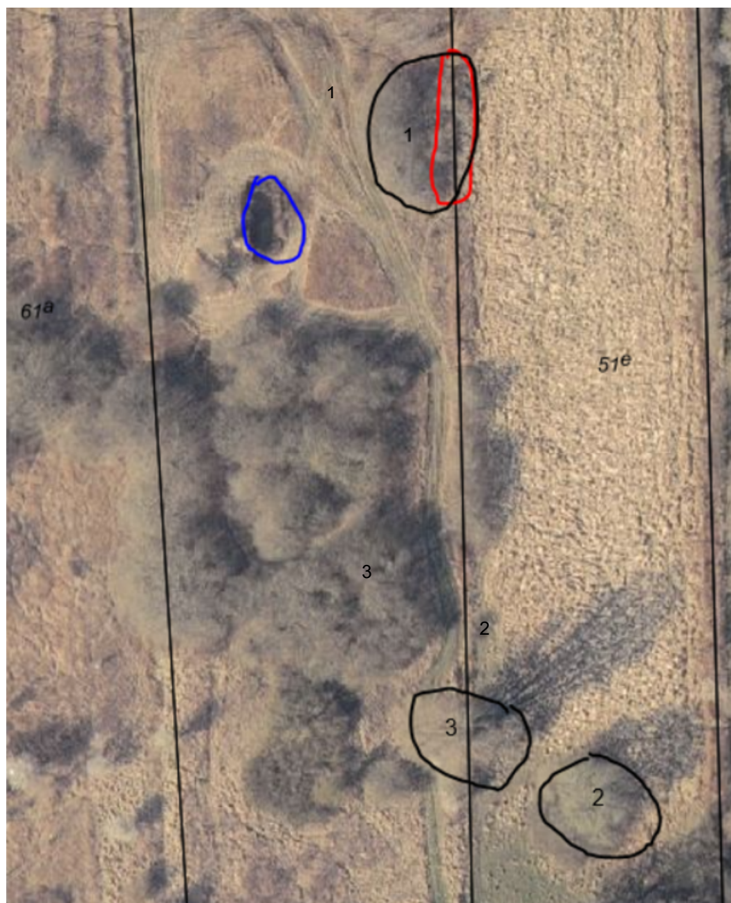
Billede 3. blå markering viser søen der ønskes oprenset. Rød markering viser placeringen af det oprensede materiale. sorte markeringer viser fjernelse af vedopvækst. I nr. 1 fjernes vedopvækst helt, nr.2 fjernes buske og i 3 beskæres et par af de nederste grene på træet.
