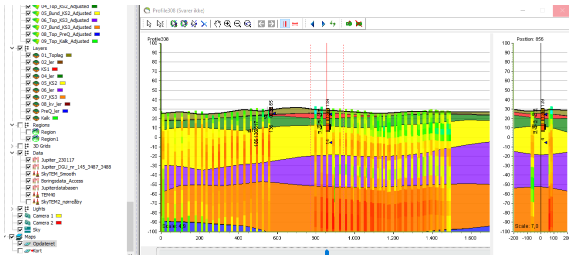
Figur 3: Hydrostratigrafisk lagserie. Der ses et ca. 4 meter tykt lerlag separere KS1 og indvindingsmagasinet KS2. Ud fra SkyTEM data og boringsdata vurderes det at der er hydraulisk kontakt mellem de regionale grundvandsmagasiner KS2 og KS3.
