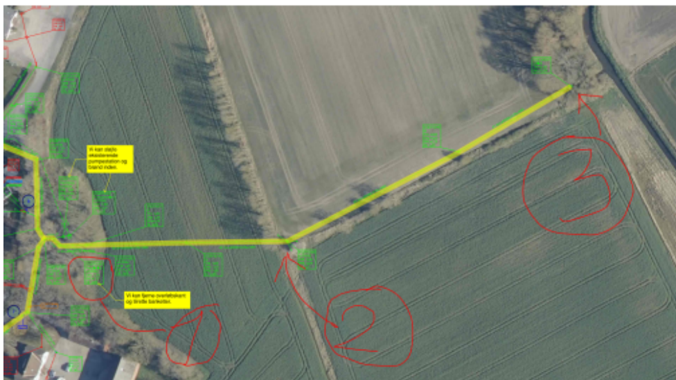
Figur 3: figuren viser at neddroslingen vil ske i udkanten af Egense, på kortet er det markeret med 1. Herefter mødes det rørlagte vandløb i punktet 2, der leder vand ud til udledningsspunktet EGEU005F i punkt 3
