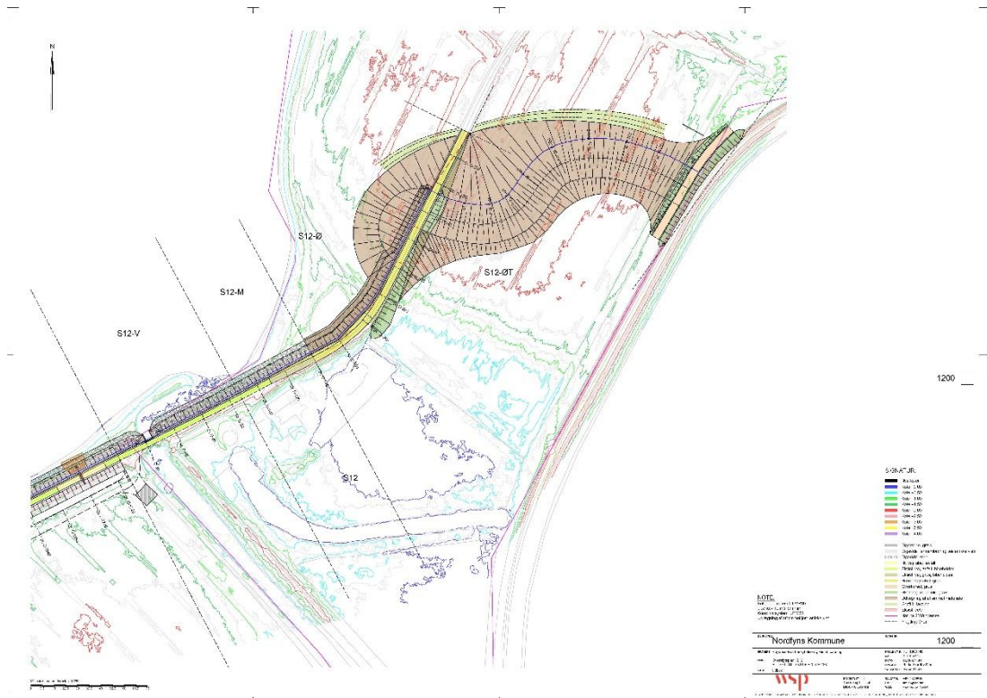
Figur 6 viser naturbaseret løsning (naturdige) som vil indgå naturligt i det nye eng og strandengsområde med mulighed for afgræsning på naturdiget samt mur og hævnning af vej på strækning 12
