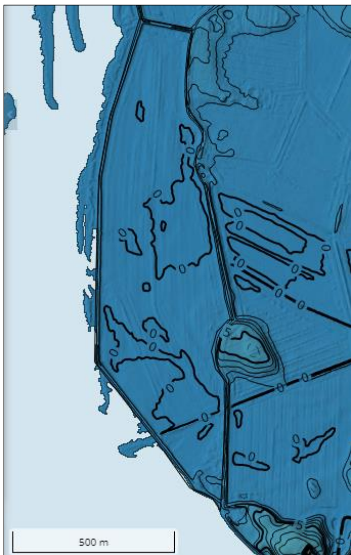
Figur 3-3 Den sorte polygon angiver projektgrænsen. Baggrundskortet er terrænmodellen fra 2018, højdekurverne er på baggrund af terrænmodellen fra 2015. Downloadet via Scalgo Live.
