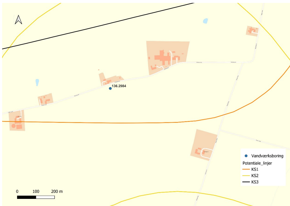
Figur 4: Grundvandspotentialet ved Maderup og Omegns Vandværks boring DGU nr. 136.2984. Grundvandspotentialet står i kote ca. 22,5 meter i det kvartære sandmagasin 3 KS3.
