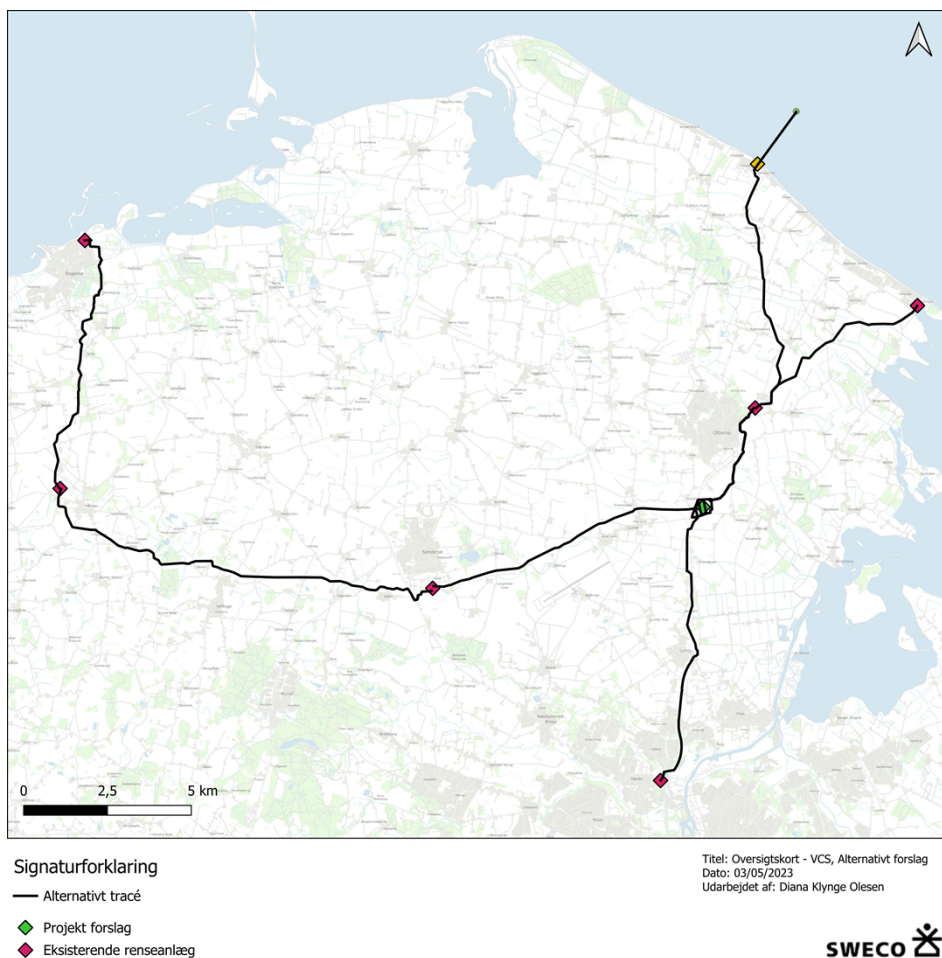
Figur 2-3. Viser placering af det nye renseanlæg (grøn firkant), placering af transportledning (trace), eksisterende renseanlæg (rød firkant), samt den alternative placering af overgangsbygværk (gul firkant) og havledning.
