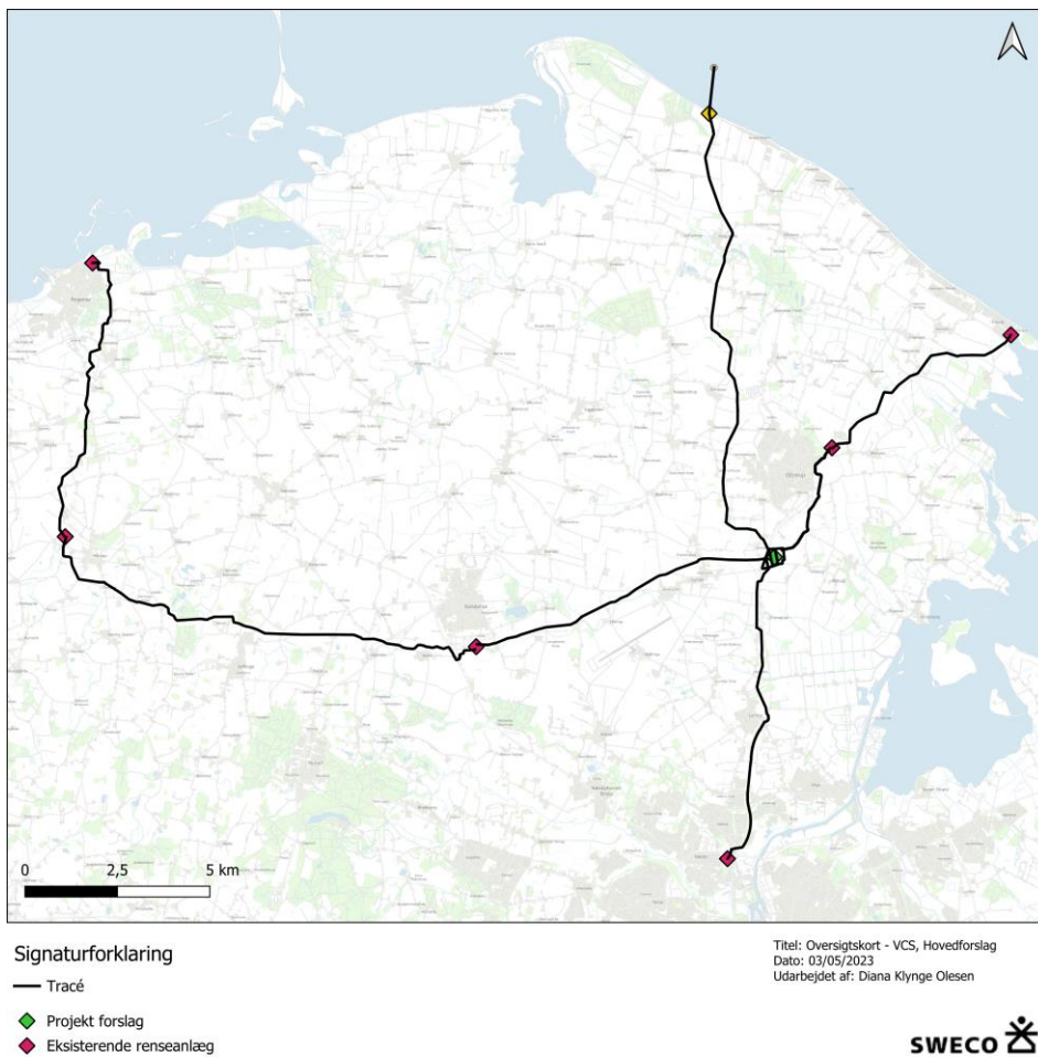
Figur 2-2. Viser hovedforslaget for placeringen af det nye renselanlæg (grøn firkant), placering af transportledning (tracé), eksisterende renselanlæg (rød firkant), udløbspunkt (gul firkant, pumpestation/overgangsbygværk) og havledning.
