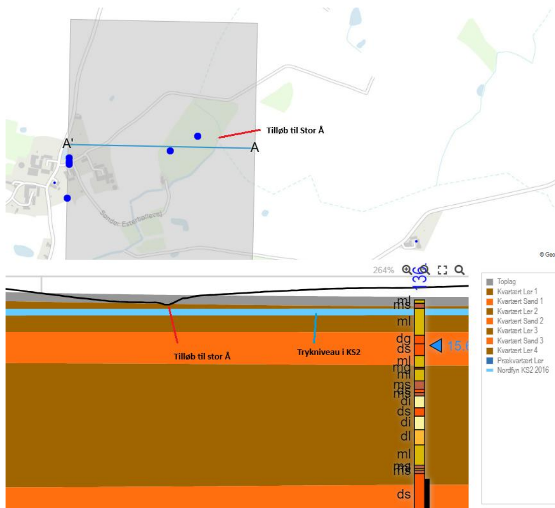
Figur 11: Grundvandsmagasinet KS2 viser spændte forhold under tilløbet, hvor vandspejlskoten (trykniveau) står ca. 1 m under vandløbsbunden. Moræneleret vurderes at medføre en begrænset udveksling af vand imellem vandløb og grundvandsmagasin.
