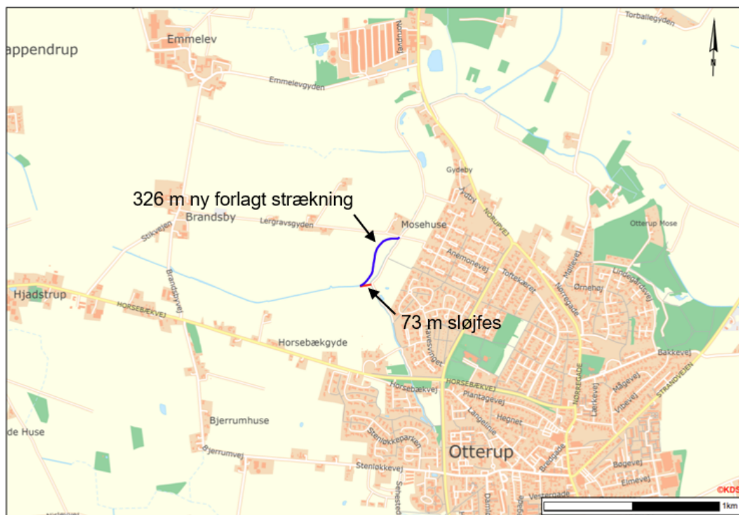
Figur 2: Oversigtskort. Den røde linje markerer placering af den 73 meter lange delstrækning af Hjadstrupfløbet st. 1.495-1.568, der sløjfes ifm. forlægningen. Den blå linje markerer placeringen af den nye 326 meter lange forlagte og forlængede delstrækning af Hjadstrupfløbet st. 1.495 – ny st. 1.894. Målestok er angivet i nederste højre hjørne. Baggrundskort © SDFI, 07.08.2026/WMS-tjeneste, skærmskud, almindeligt.
