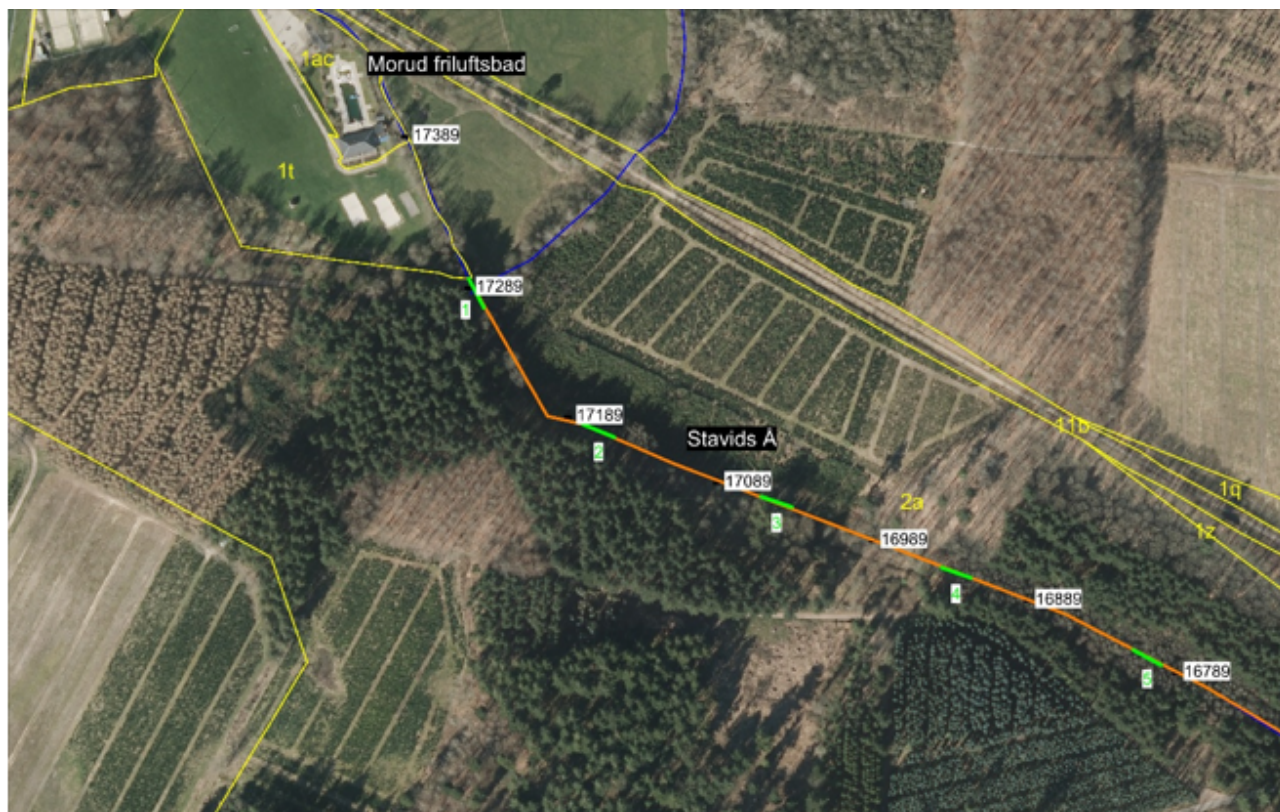
Figur 2: Oversigtlig fremstilling af projektskitse med angivelse af omlægning af eksisterende vandløbsbund (orange streg) og etablering af nye gydestryg (grøn streg). Eksisterende vandløb er angivet med blå streg, stationering med sort markering og matrikelgrænser med gul streg og nummer.
