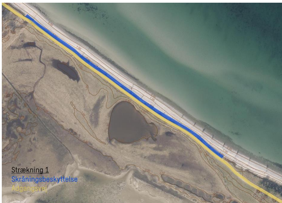
Figur 4 Overordnet planløsning af skråningsbeskyttelsen for strækning 1, 390 m.
