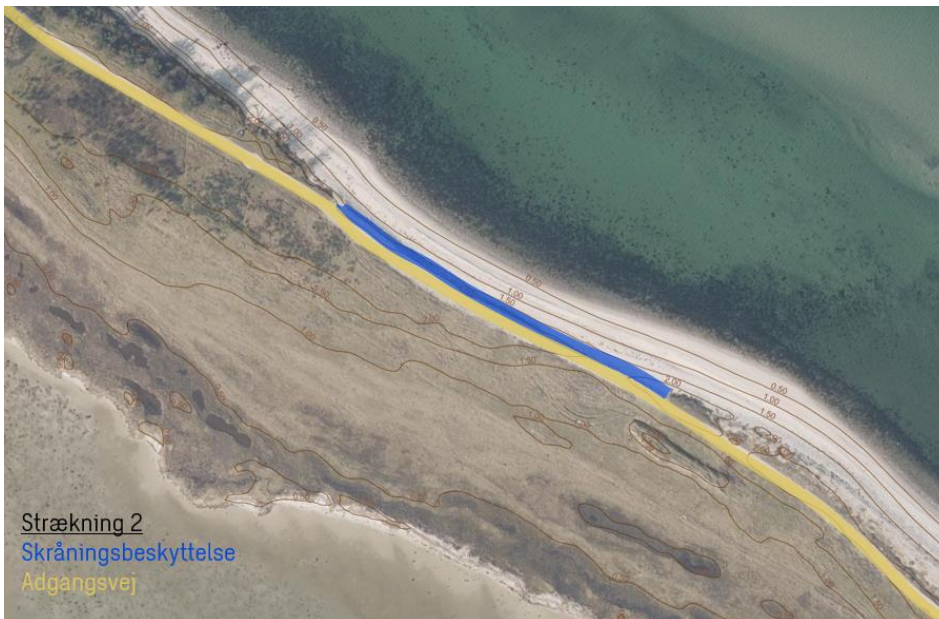
Figur 5 Overordnet planløsning af skråningsbeskyttelsen for strækning 2, 130 m.
