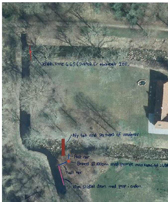
Figur 1: Placering af dræn med slidser (indvindingssted)
