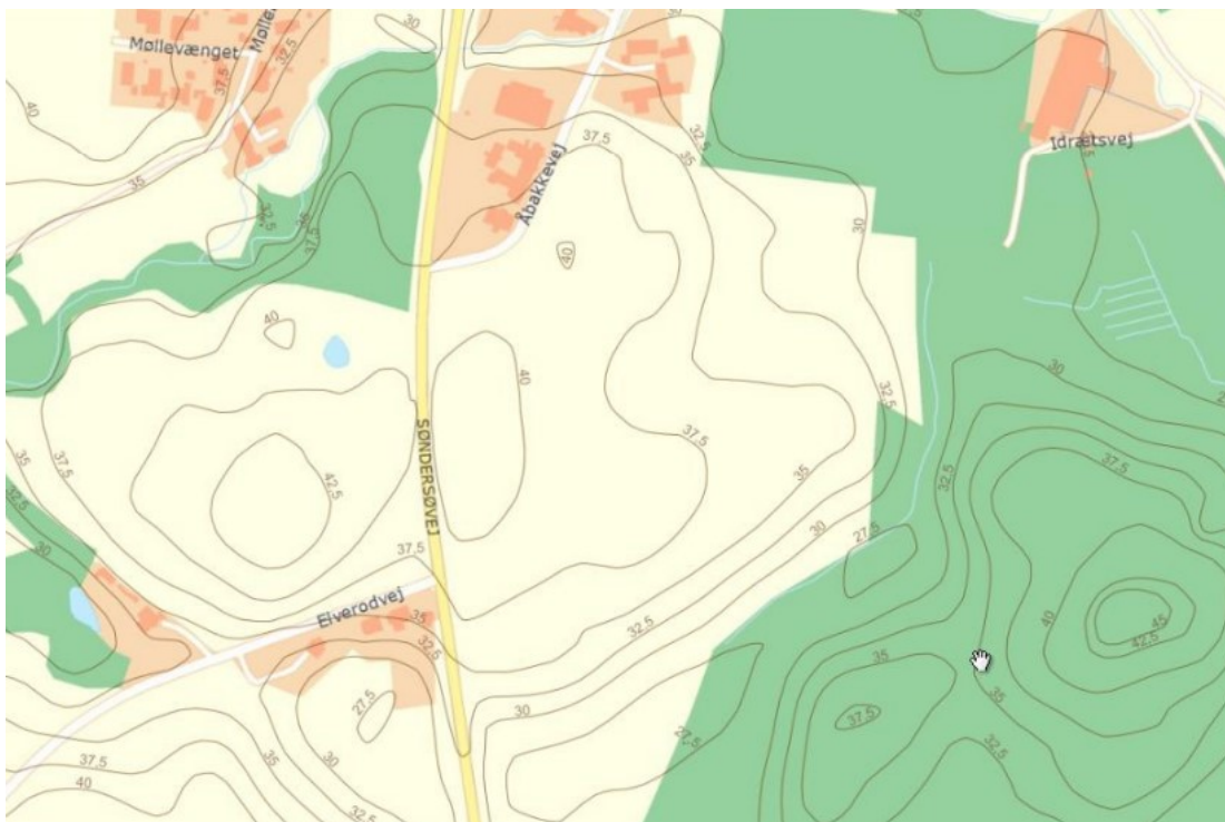
Figur 3, Højdekurver i et kuperet terræn.
