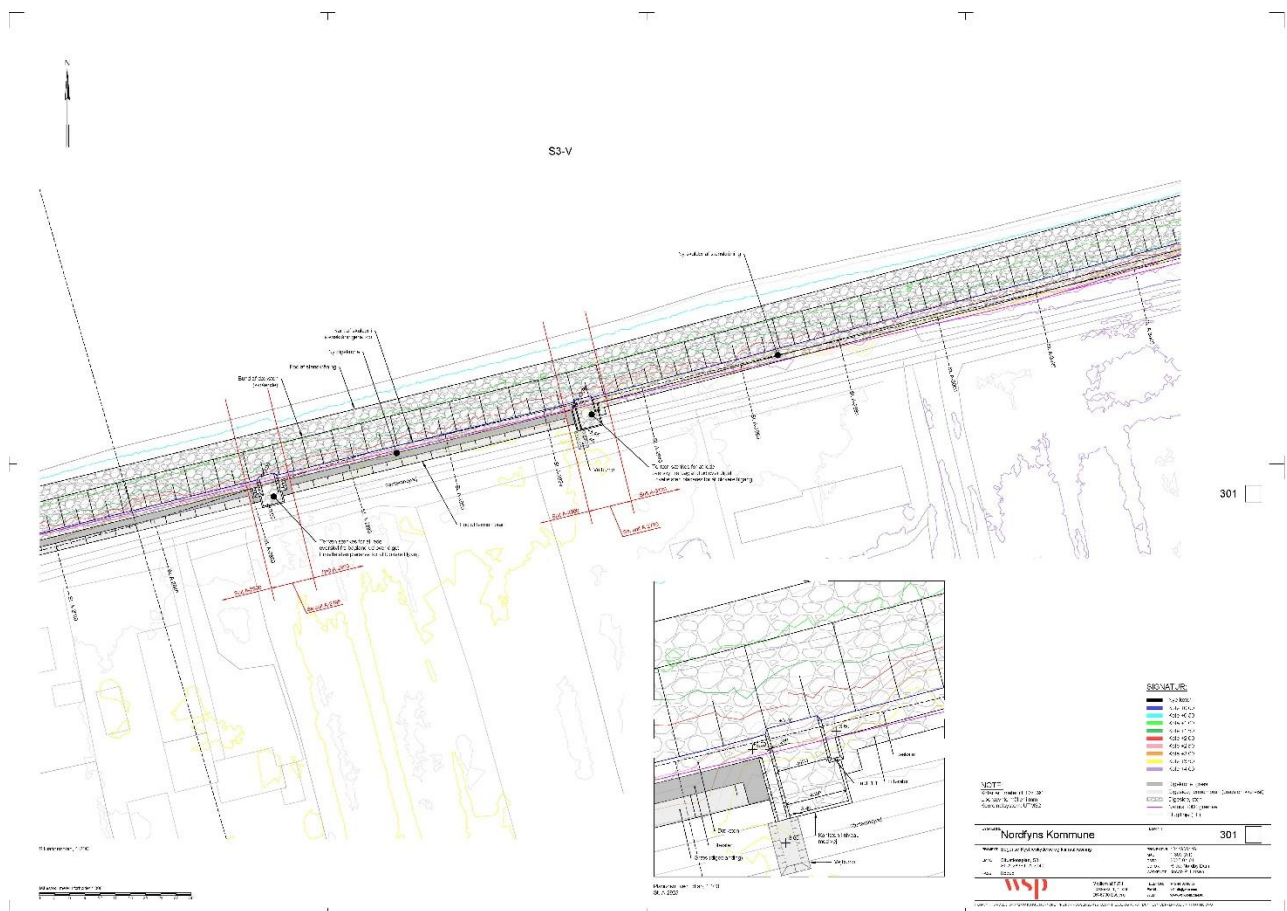
Figur 13 viser plantegning med render til afhjælpning af overskyl på strækning 3 (S3 V)
