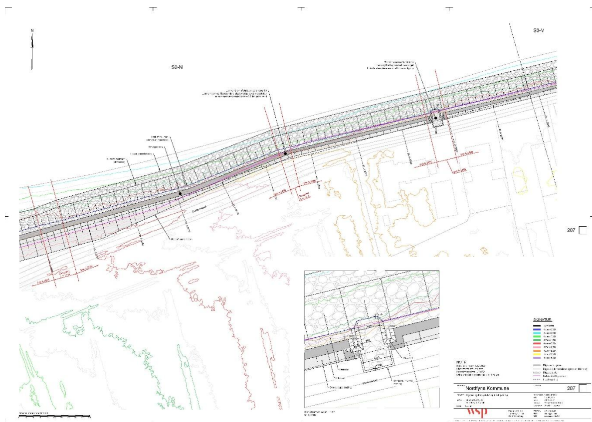
Figur 12 viser plantegning med rende til afhjælpning af overskylproblematikken på strækning 2 (S2-N).
