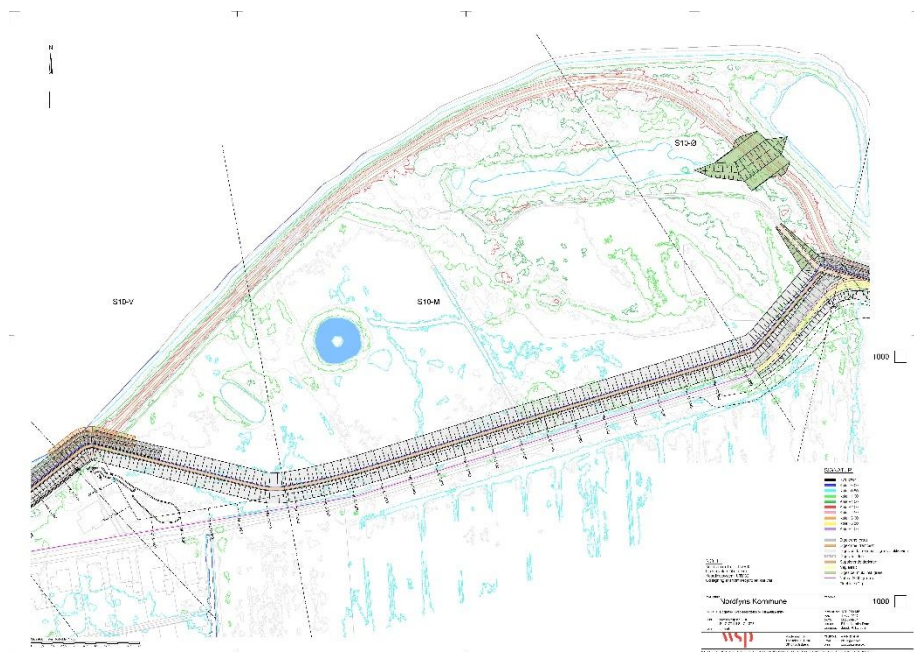
Figur 1 viser plantegning over strækning 10, hvor eksisterende dige bibeholdes uden sten og beton til naturlig erosion, men at der samtidig laves en rende til periodevis overskyl af område foran tilbagetrukket dige en gang imellem for at fremme dannelsen af strandeng.
