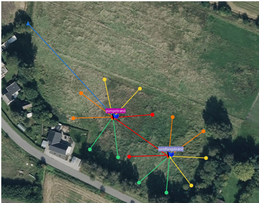
Billede 2 - Billede over planlagt dræning, sandfang, pumpebrønd og placering af udledning i Agerland Rende Syd.
