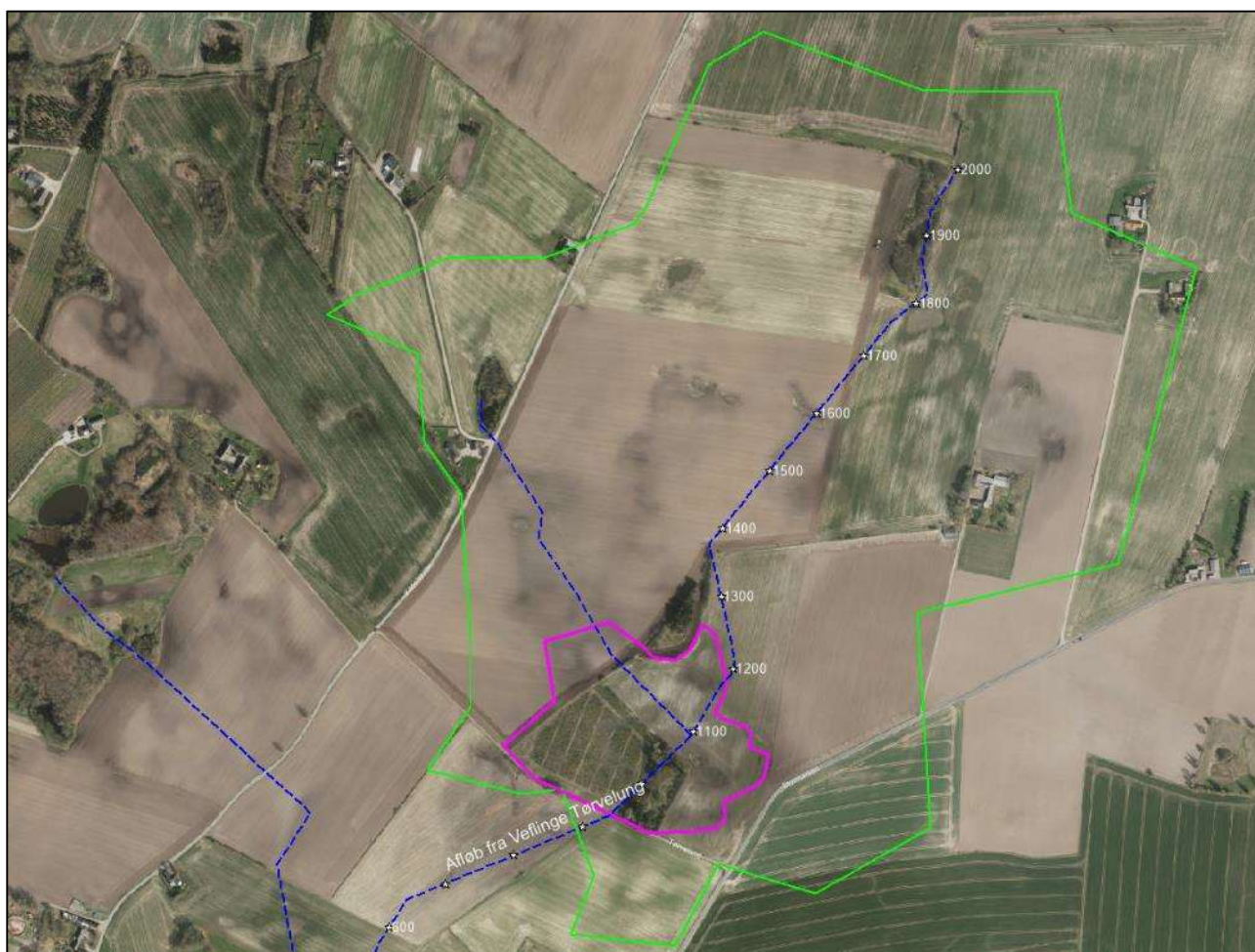
Figur 8: Oplandskort for undersøgelsesområdet. Oplandet er opgjort på baggrund af oplandskort fra DMU og oplysninger om dræn og terrænforhold.
