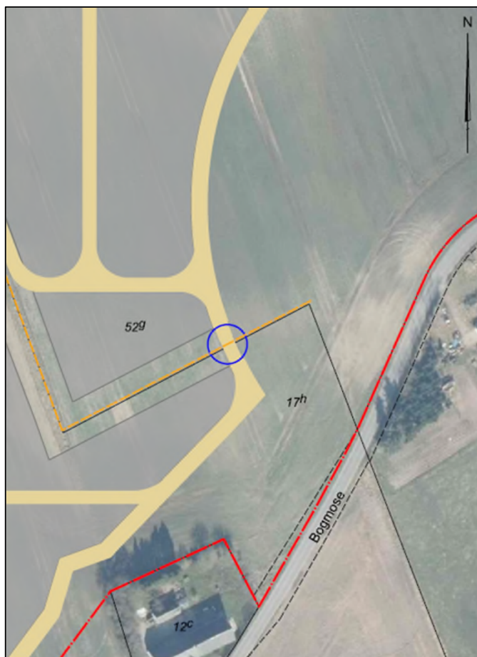
Figur 6: Digegennembrud D. Det beskyttede sten- og jorddige er vist med en orangestiplet linje, serviceveje er vist med beige flader og byggefelter er vist med grå transparente flader. Digegennembruddet er markeret med en blå cirkel.
