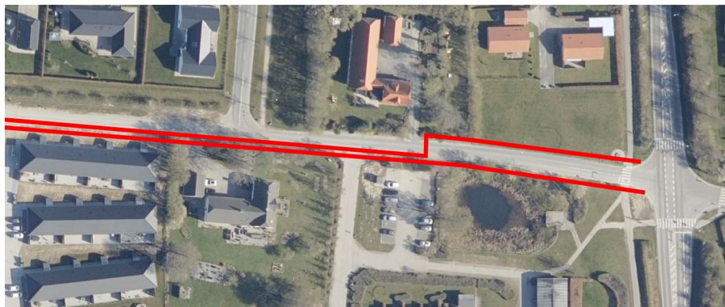
Figur 0.2: Principskitse af en alternativ løsning, hvor cykelstien føres forbi gadekæret som to enkelttrettede cykelstier, for så at samles til en dobbelttrettet cykelsti vest for gadekæret.
