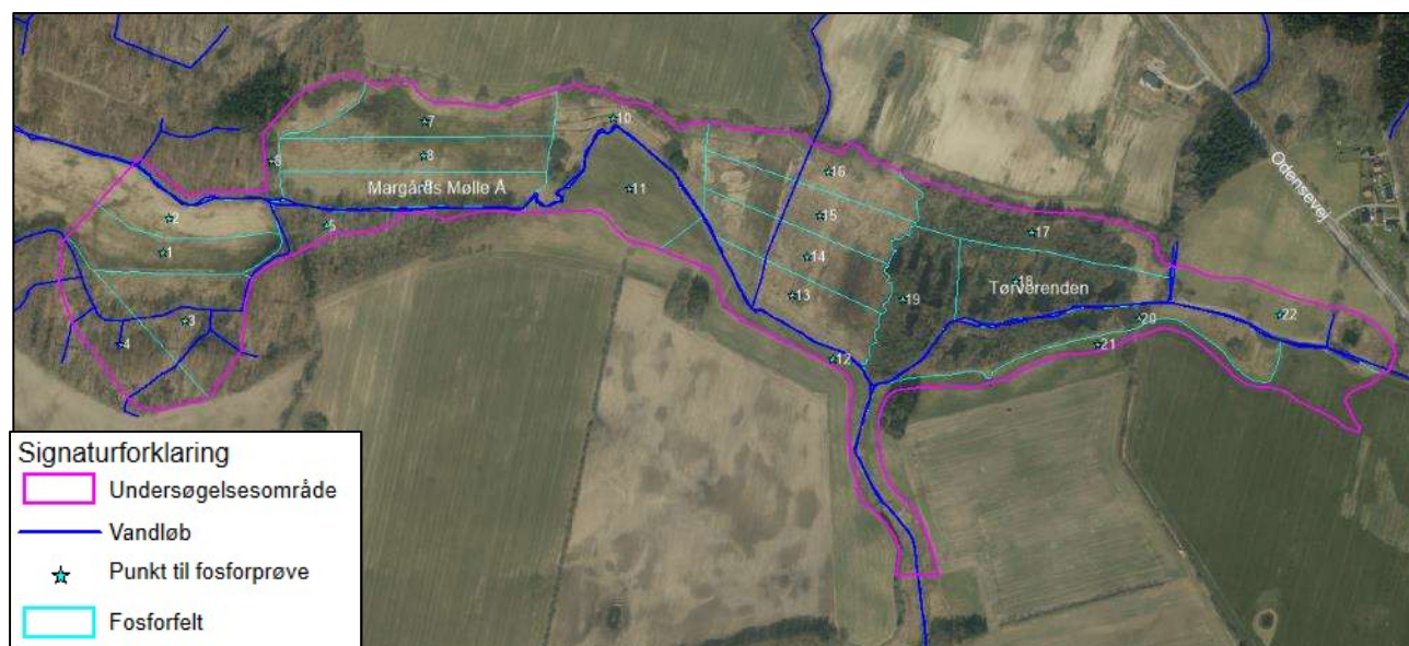
Figur 35: Prøvefelter til udtagning af jordprøver til fosforanalyser og punkter for udtagning af prøver til bestemmelse af volumenvægt og jordbundsbeskrivelse.
