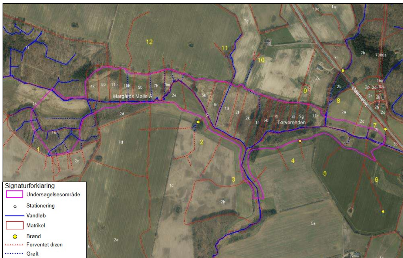
Figur 13: Dræn-/afvandingsystemer registreret af rådgiver i forbindelse med besigtigelsen i 2019.
