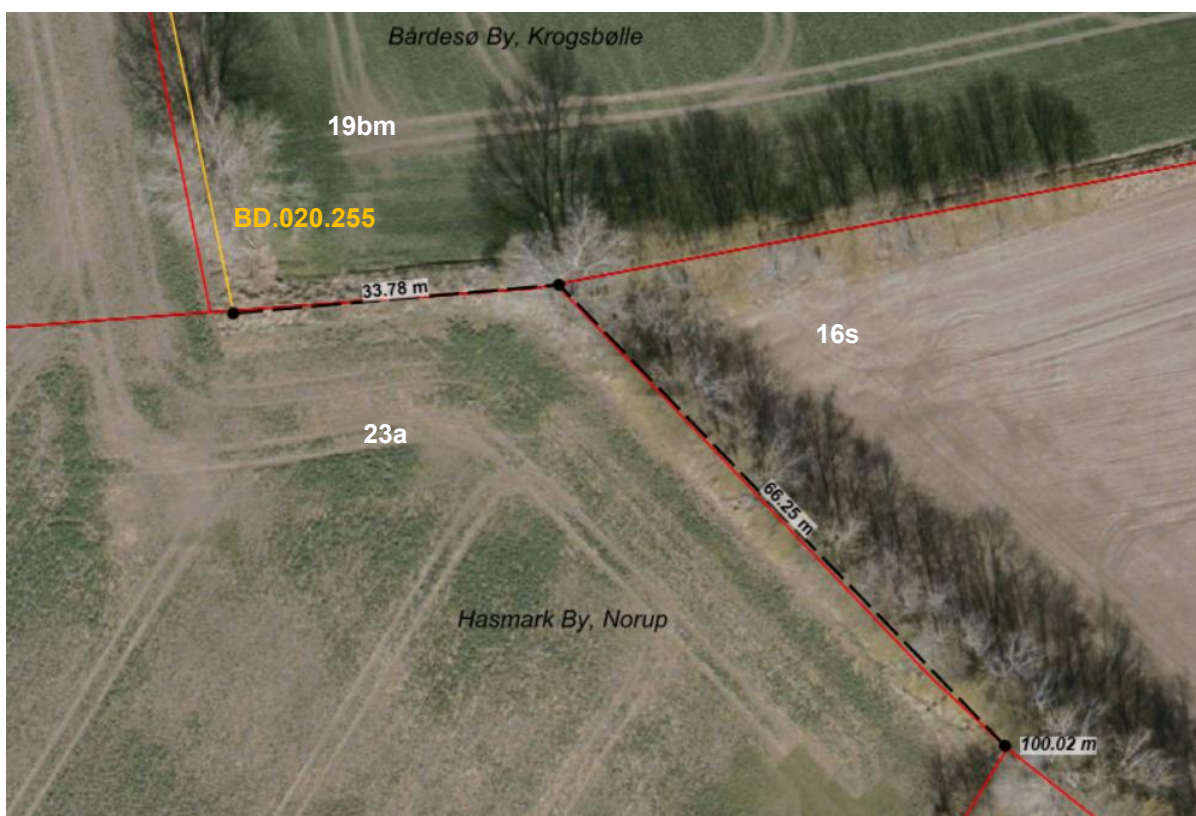
Billede 12 viser opmåling af den østlige og sydøstlige forlængelse af diget BD.020.255, som hidtil er ubeskyttet. Matrikelnumrene er angivet med hvidt.
