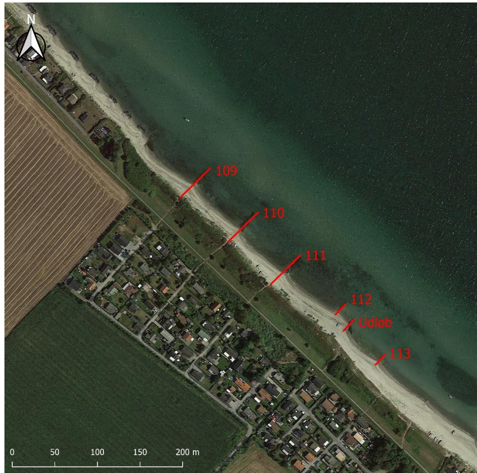
Figur 5-1 Eksisterende høfder (markeret med rød). De tre nordligste høfder (nr. 109 – 111) vurderes fra fotos til at bestå delvis af beton.
